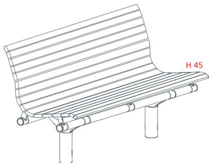
Panchina in legno con basi di fissaggio diretto a pavimento
